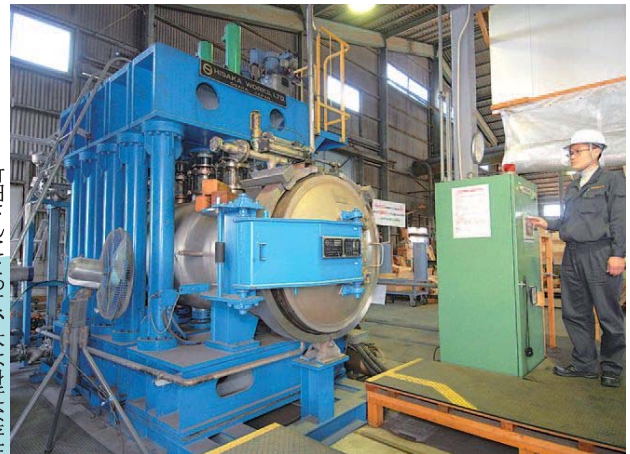
直径90センチ×奥行3メートルの圧力容器で作り上げる
